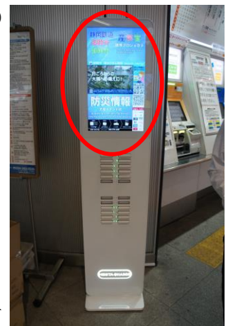
写真1 新静岡駅に設置しているスタンド(24ロモデル、サイネージ23.8インチ)
